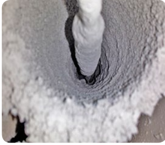
Feinstaub bleibt an der Abscheidefläche und an der Elektrode haften. Bei steigender Staubbilddung der Elektrode passt die intelligente Regelung die Stromwerte an, um die Abscheideleistung beizubehalten.
