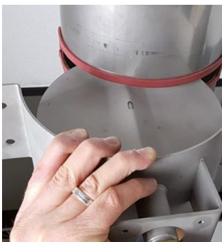
4. Nach dem zusammensetzen der Klappe und der Halbschale mit Motoraufnahme, kann die Klappe durch die Einbauöffnung in das Abgasrohr geschoben werden
